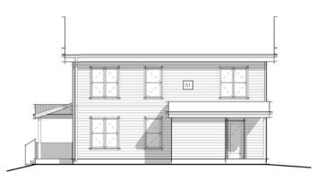
DUPLEX BB- RIGHT ELEVATION ELEVATION 1/16" = 1'-0"
