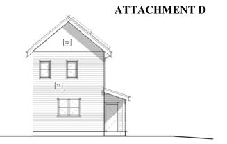
SINGLE FAMILY B - REAR ELEVATION ELEVATION 1/16" = 1'-0"
